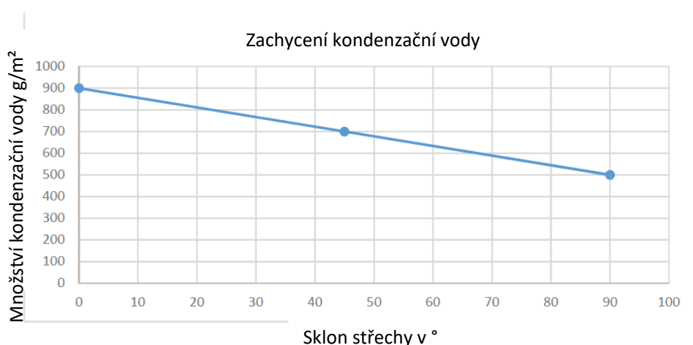
Grafika 2: Schopnost zachytit kondenzační vodu v závislosti na sklonu střechy
